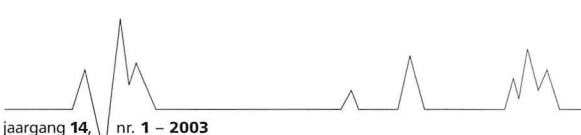
Figuur 2a: Chromatogram met vrij pertechnetaat aan het front: labelingspercentage is 89%.
